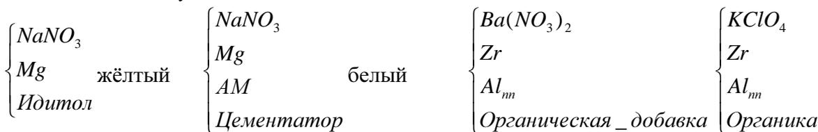
При серийной обработке составы, содержащие цирконий и перхлорат калия, чрезвычайно опасны.
